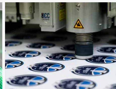
CNC Fräsmaschine im Format ca. 3 x 2 m inkl. Conveyorband für Endloslänge
